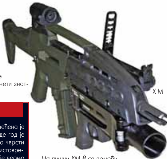
На пушци XM 8 се помоћу Пикатинијеве шине монтира потцевни бацач граната XM 320
